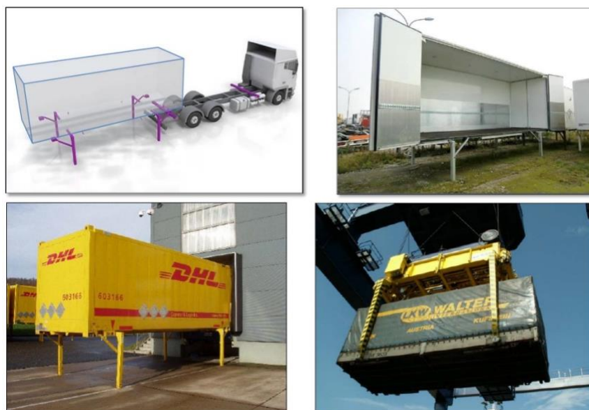
Рисунок 2.53 – Съемные кузова. Установка на шасси автомобиля (вверху слева); СК с раскрывающейся боковой стенкой (вверху справа); обработка СК на складе (внизу слева); перегрузка на интермодальном терминале (внизу справа).
