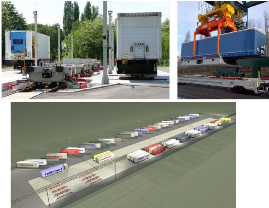
Рисунок 2.59 – Система Cargo Beamer: автоматизированная загрузка (вверху слева), погрузка кассеты с полуприцепом на интермодальном терминале (вверху справа), терминал (внизу). (Источник: https://www.cargobeamer.eu/ )
