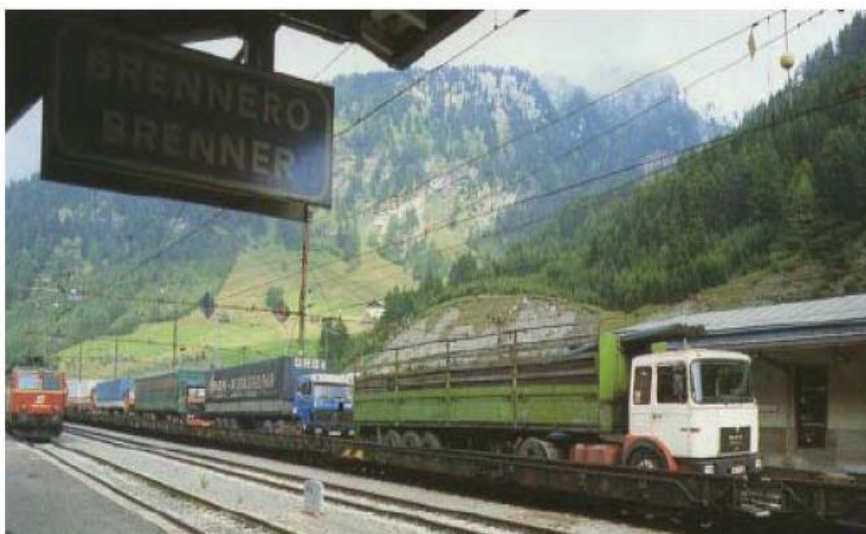
Рисунок 2.56 – Система Rolling Highway («катящееся шоссе», сокращенно Ro-La)
