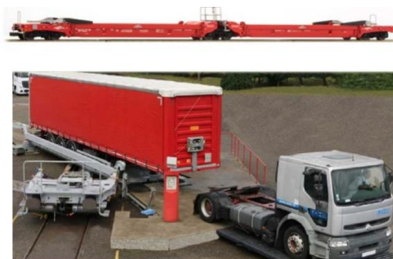
Рисунок 2.57 – Система Modalohr. Сочлененный вагон (вверху), погрузка полуприцепа
