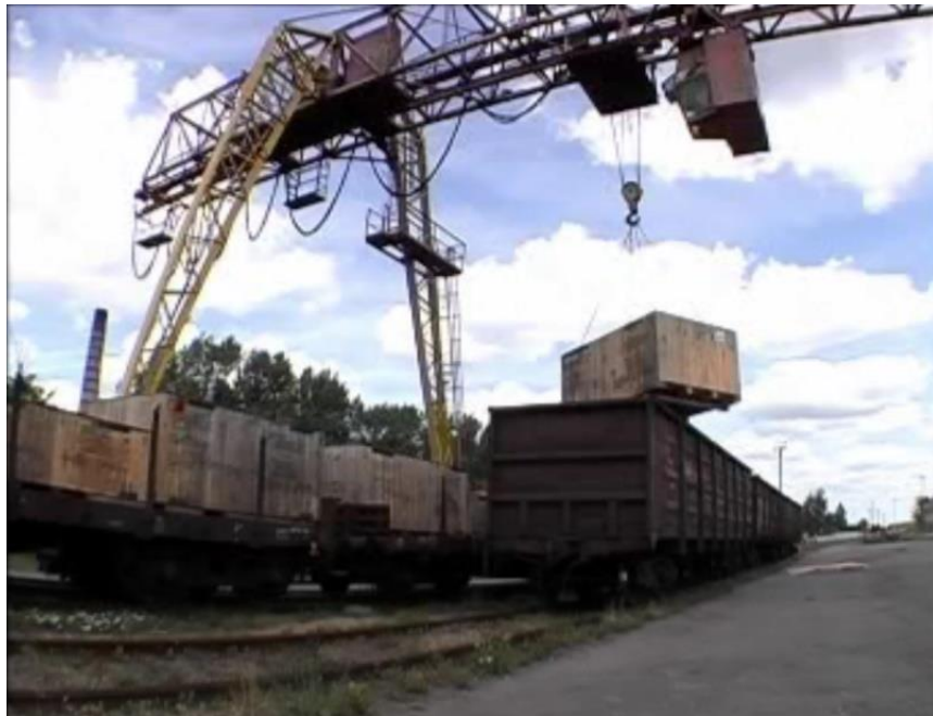
Рисунок 2.29 – Перевалка груза из вагонов колеи 1453мм в вагоны колеи 1520мм (или наоборот)
