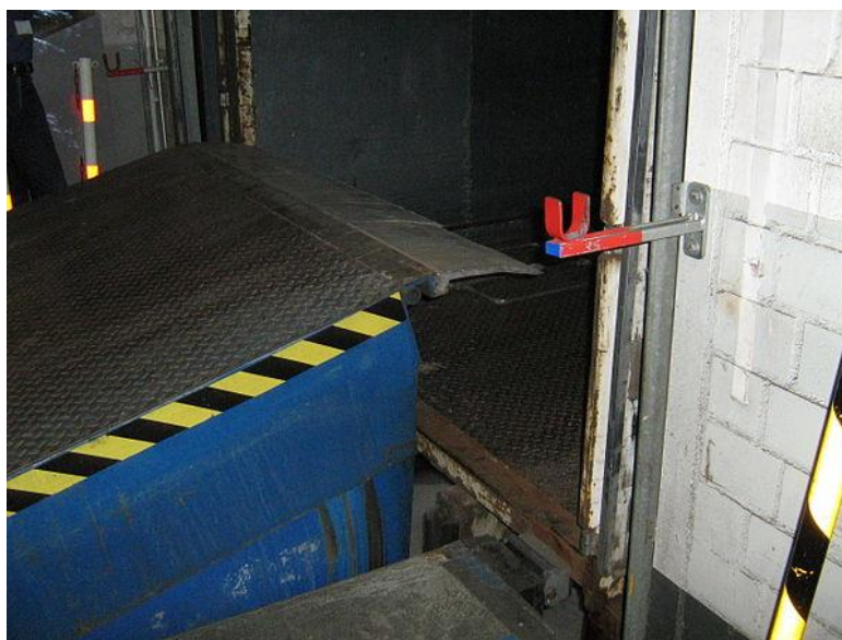
Рисунок 3.12 – Установка платформы доквеллера к кузову автомобиля для ускорения ПРР со склада в автомобиль автопогрузчиком
