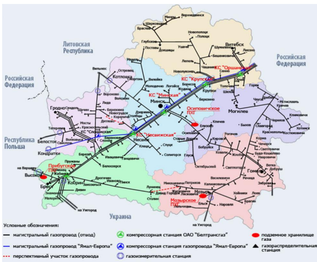
Рисунок 2.66 – Газовая трубопроводная система Беларуси
