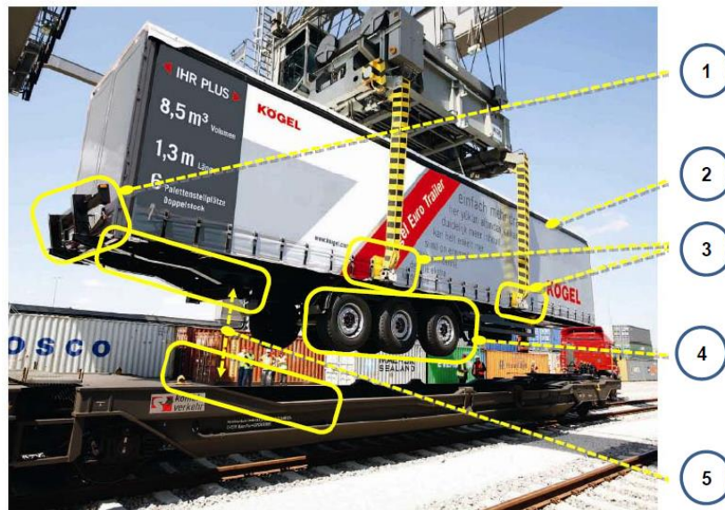
Рисунок 2.55 – Конструктивные особенности полуприцепа, пригодного для вертикальной перегрузки: 1 – откидной противоподкатный буфер; 2 – усиленное крепление крыши; 3 – проемы для клещевых захватов, окантовка тента вокруг проемов, усиленная рама; 4 – определенное положение тележки на раме; 5 – профиль рамы, соответствующий профилю вагона. Источник: Kogel Trailer GmbH, сайт компании
